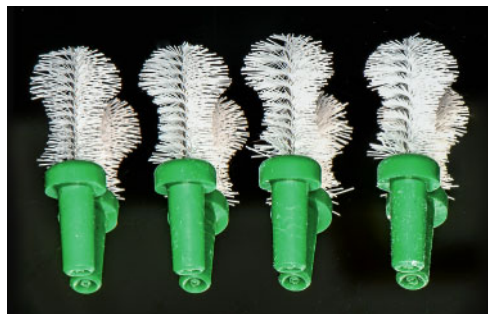
Abb. 2 Testbürsten (Prototypen) mit 200, 250, 300 oder 350 Filamenten.
